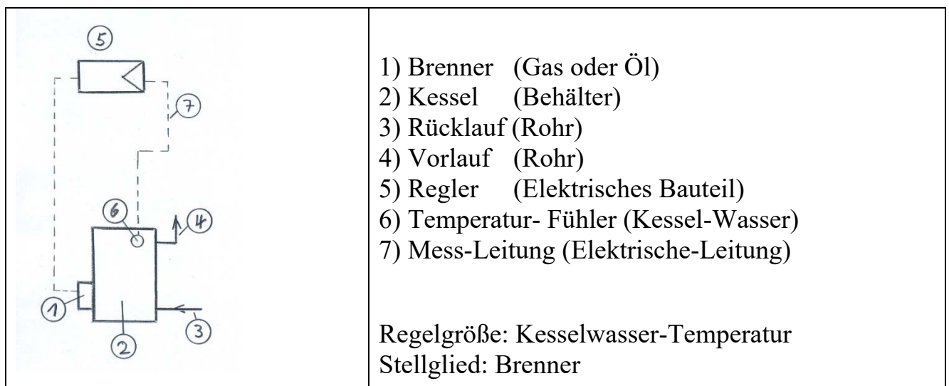
Bild 1: Regelschema einer „Kesselwasser-Temperatur-Regelung“
