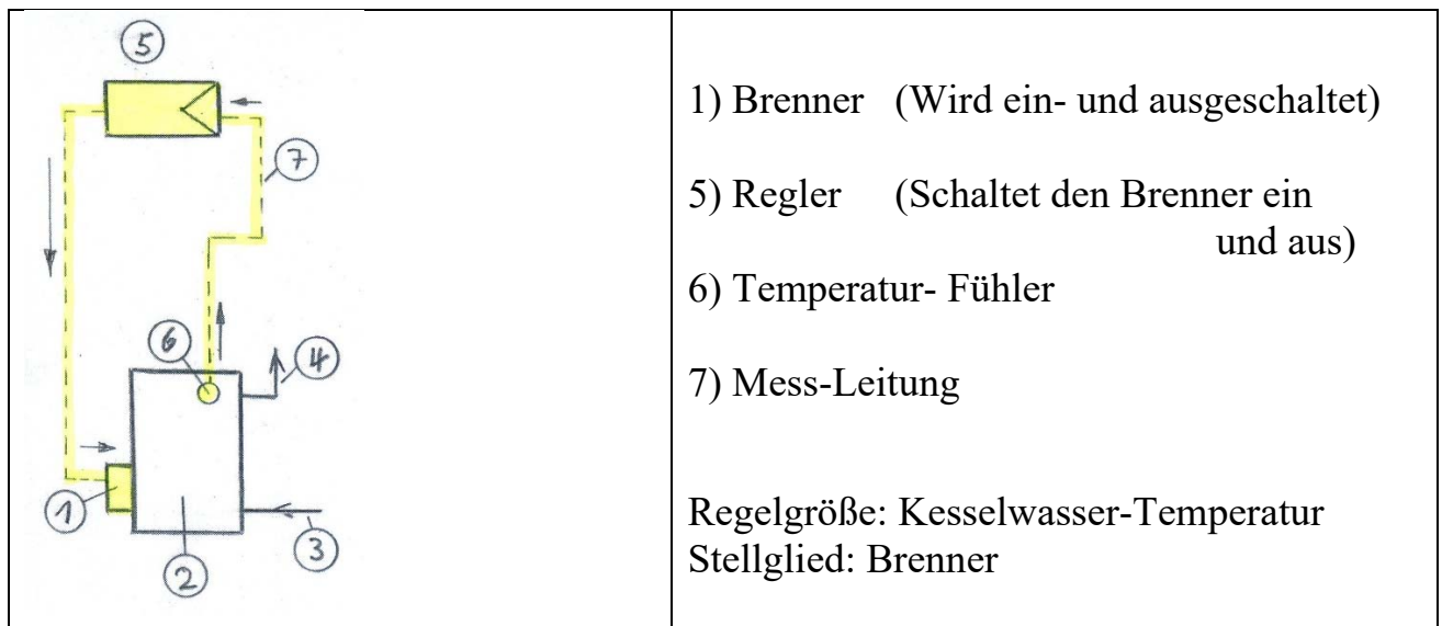
Bild 2: Regelschema einer „Kesselwasser-Temperatur-Regelung“
